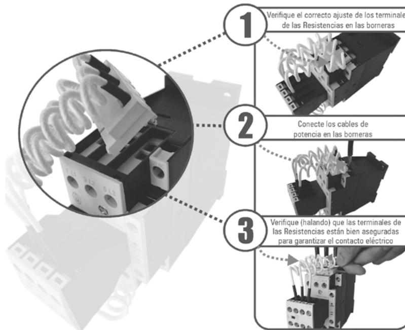
Los contactores para condensadores DILK han sido desarrollados a partir de los contactores DILM. La instalación y conexión, así como el manejo, son idénticos a los contactores estándar. Estos contactores incluyen resistencias en serie, además de un material especial en los contactos libre de soldaduras. Los condensadores se cargan previamente mediante un contacto auxiliar avanzado especial, y sólo entonces se cierran los contactos principales y conducen la intensidad.
