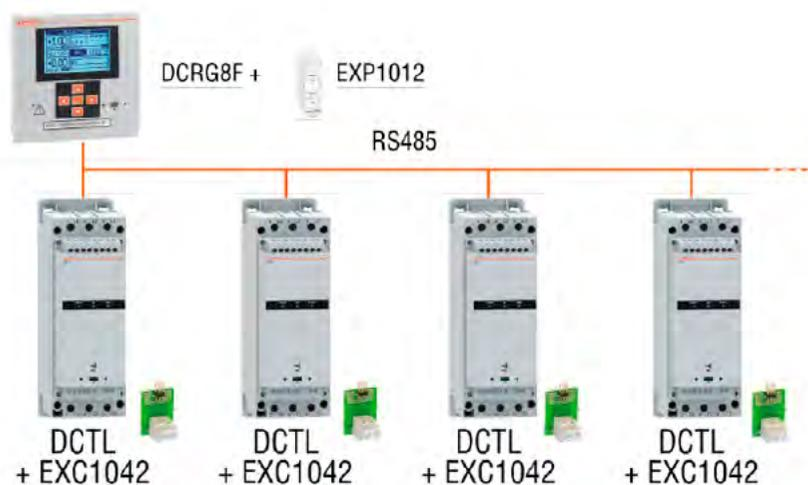
Alternativamente al comando estándar de salidas estáticas, los módulos de tiristores tipo DCTL se pueden conectar al controlador de factor de potencia automático tipo DCRG8F con Puerto opcional RS485 (código EXC1042), obteniendo un sencillo y cableado lineal.
