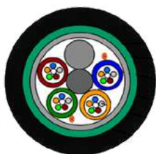
Fibra óptica ext. Con armadura
