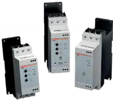
Los arrancadores suaves serie ADXN son la solución ideal para quienes necesitan un producto simple, compacto y de rápido de configurar, para el control gradual del arranque y de la parada de los motores. Su versatilidad los hace adecuados para varias aplicaciones como el control de bombas, ventiladores, cintas transportadoras, compresores y están disponibles en corrientes nominales de 6 a 45A.
