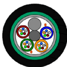
Fibra óptica ext. Con armadura
