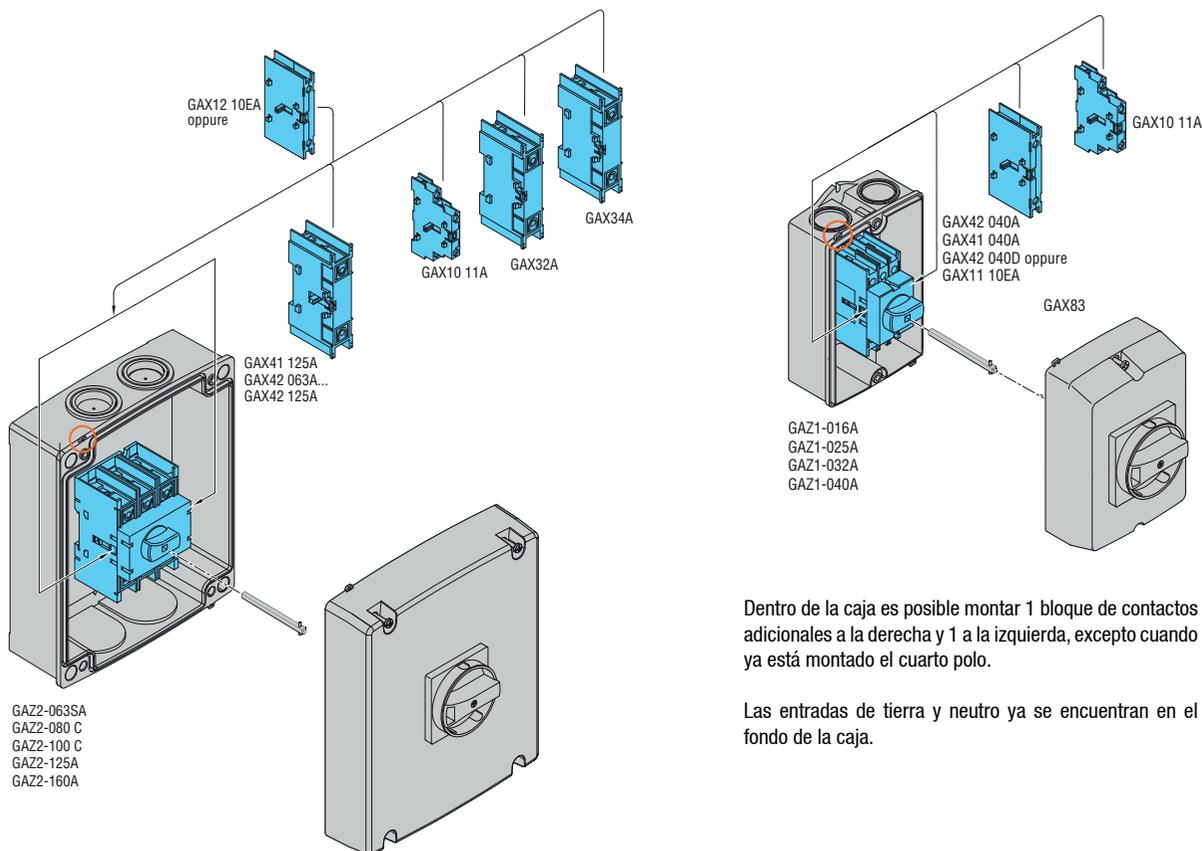
Dentro de la caja es posible montar 1 bloque de contactos adicionales a la derecha y 1 a la izquierda, excepto cuando ya está montado el cuarto polo.
