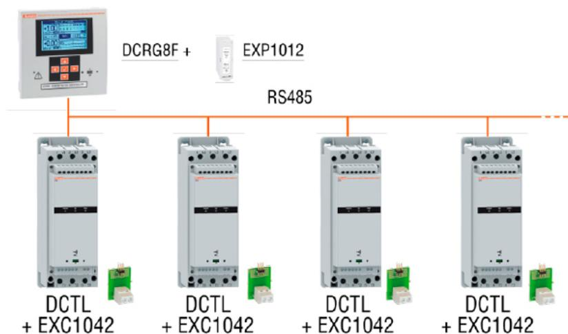
Alternativamente al comando estándar de salidas estáticas, los módulos de tiristores tipo DCTL se pueden conectar al controlador de factor de potencia automático tipo DCRG8F con Puerto opcional RS485 (código EXC1042), obteniendo un sencillo y cableado lineal.
