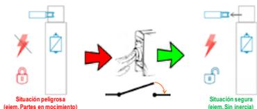
En caso de apagarse la máquinas o faltar el suministro las barreras de seguridad se mantienen cerradas.
