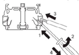
Extracción cables (siempre con destornillador plano)
