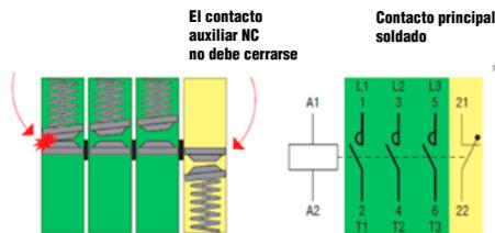
BLOQUE DE CONTACTO AUXILIAR NO EXTRAÍBLE DEL CONTACTOR PARA EVITAR MANIPULACIONES
