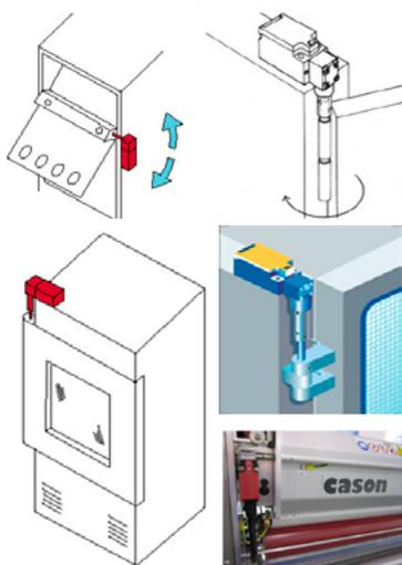
**CONTACTOS ACCIÓN LENTA:** El desplazamiento de los contactos se ejecuta a una velocidad proporcional a la velocidad de operación externa. Cada movimiento del operador se transforma en un movimiento de los contactos eléctricos.
