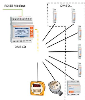
**COMPATIBILIDAD MÓDULOS DE EXPANSIÓN MONTAJE EN RIEL**
