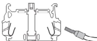
Cableado con ayuda de destornillador plano (con cables flexibles sin terminal de punta)
