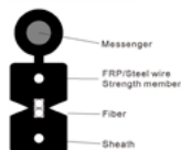
Fibra óptica DROP exterior
