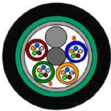
Fibra óptica ext. Con armadura
