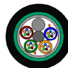
Fibra óptica ext. Con armadura
