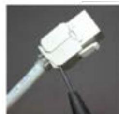
Corte la correa. Use un destornillador plano para desbloquear el conector.
