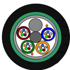
Fibra óptica ext. Con armadura
