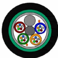
Fibra óptica ext. Con armadura
