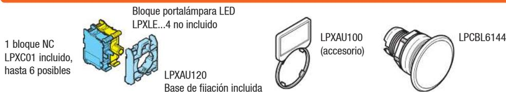
**PULSADORES TIPO HONGO LUMINOSOS CON RETENCIÓN, PARADA DE EMERGENCIA, DESBLOQUEO POR ROTACIÓN, IP66 - IP67 - IP69K (NO INCLUYE BLOQUE PORTALAMPARA LED)**
