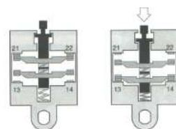
**CONTACTOS DE ACCIÓN BRUSCA:** El desplazamiento de los contactos se ejecuta a una velocidad independiente de la velocidad externa del operador; La conmutación se realiza bruscamente una vez el punto de basculamiento se alcanza. Cada movimiento del operador no causa algún movimiento de los contactos eléctricos a menos que el punto de basculamiento se alcance.
