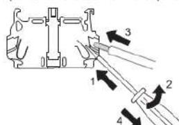
Extracción cables (siempre con destornillador plano)
