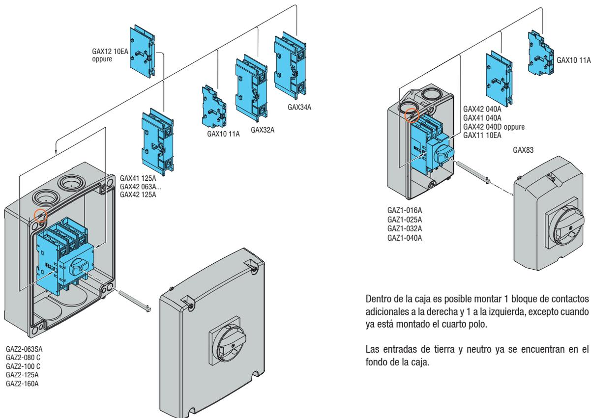
Dentro de la caja es posible montar 2 bloques de contactos adicionales a la derecha y 2 a la izquierda, excepto cuando ya está montado el cuarto polo.
