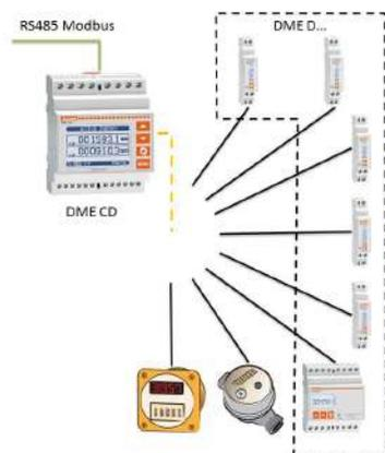
**COMPATIBILIDAD MÓDULOS DE EXPANSIÓN MONTAJE EN RIEL**
